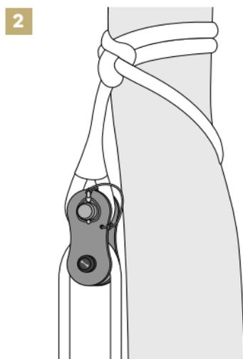
Retirar el pasador, deslizar el eje superior y abrir el brazo oscilante. Colocar la cuerda de retención en la garganta de la roldana, instalar una eslinga textil (o correa) en el eje superior. Cerrar el brazo oscilante y el eje superior, bloquear con el pasador de seguridad y verificar que la anilla esté enganchada en la muesca de seguridad.
